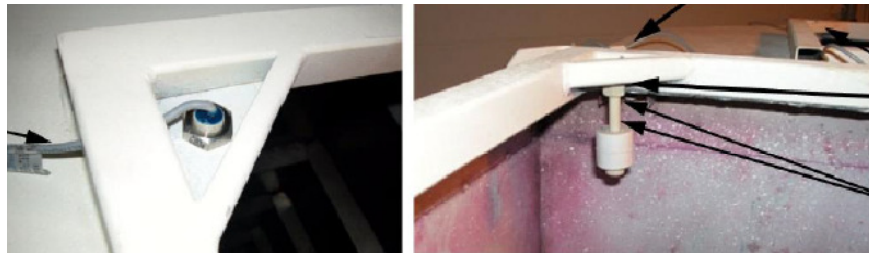
Figura 16 – Sensores indicativos del nivel del autoblandaje líquido de un ciclotrón.
