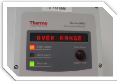
Figura 10 – Indicación de superación de los niveles de referencia de tasa de dosis.
