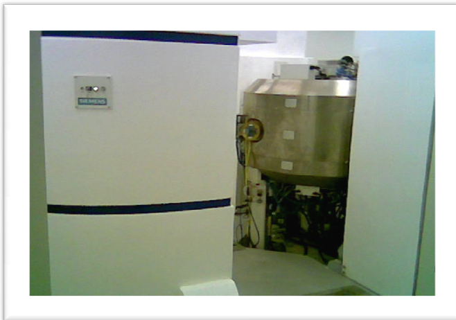
Figura 7– Ilustración de un ciclotrón con los autoblandajes abiertos.
