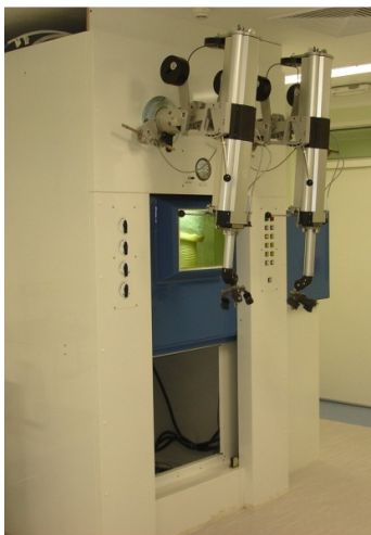
Figura 4 –Ilustración de una celda caliente con manipuladores.
