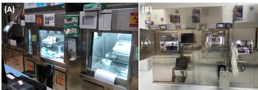
**Figura 4:** (A) Radiofarmacia equipada con campanas de flujo laminar. (B) Modelo de celdas calientes para uso en radiofarmacias (Colección CNEN/Brasil).
