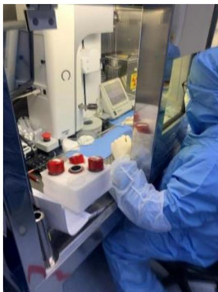
**Figura 5:** Campana equipada con robot semiautomático para el fraccionamiento de dosis (Colección CNEN/Brasil).
