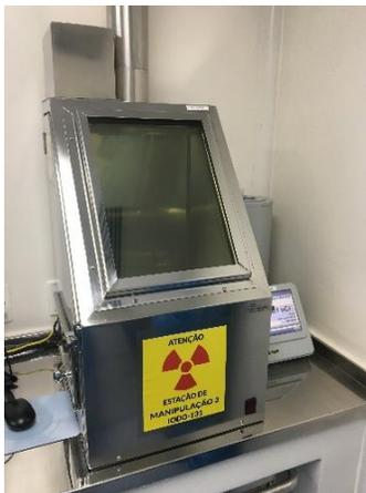
**Figura 6:** Cajas de guantes para la manipulación de fuentes no selladas volátiles (Colección CNEN/Brasil).
