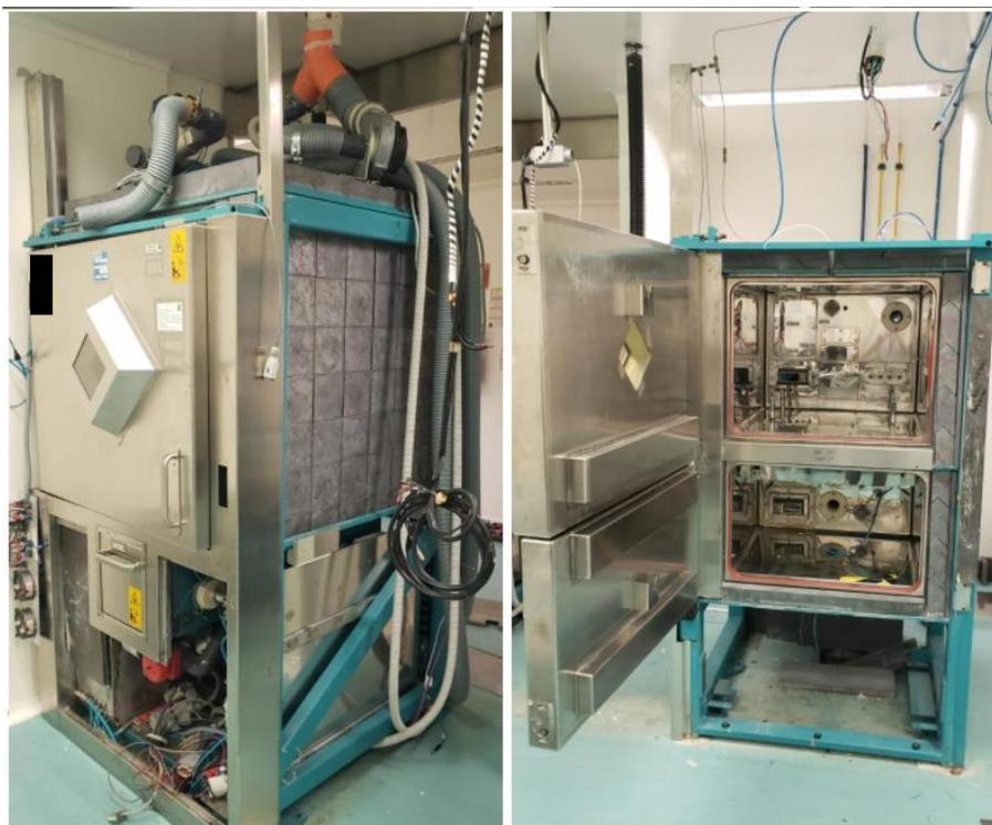
**Figura 21:** Etapa de montaje de la celda caliente (Colección CNEN/Brasil).
