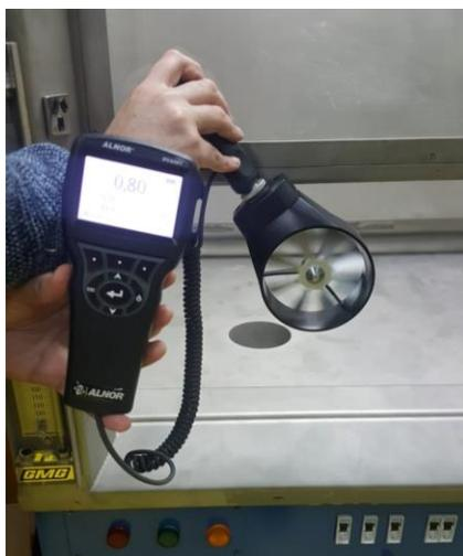
**Figura 22:** Medición de velocidad de ingreso de aire en la campana (Colección ARN/Argentina).
