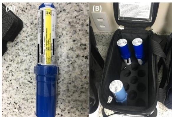
**Figura 17:** (A) Blindaje para monodosis y (B) embalaje para el transporte de monodosis (Colección CNEN/Brasil).
