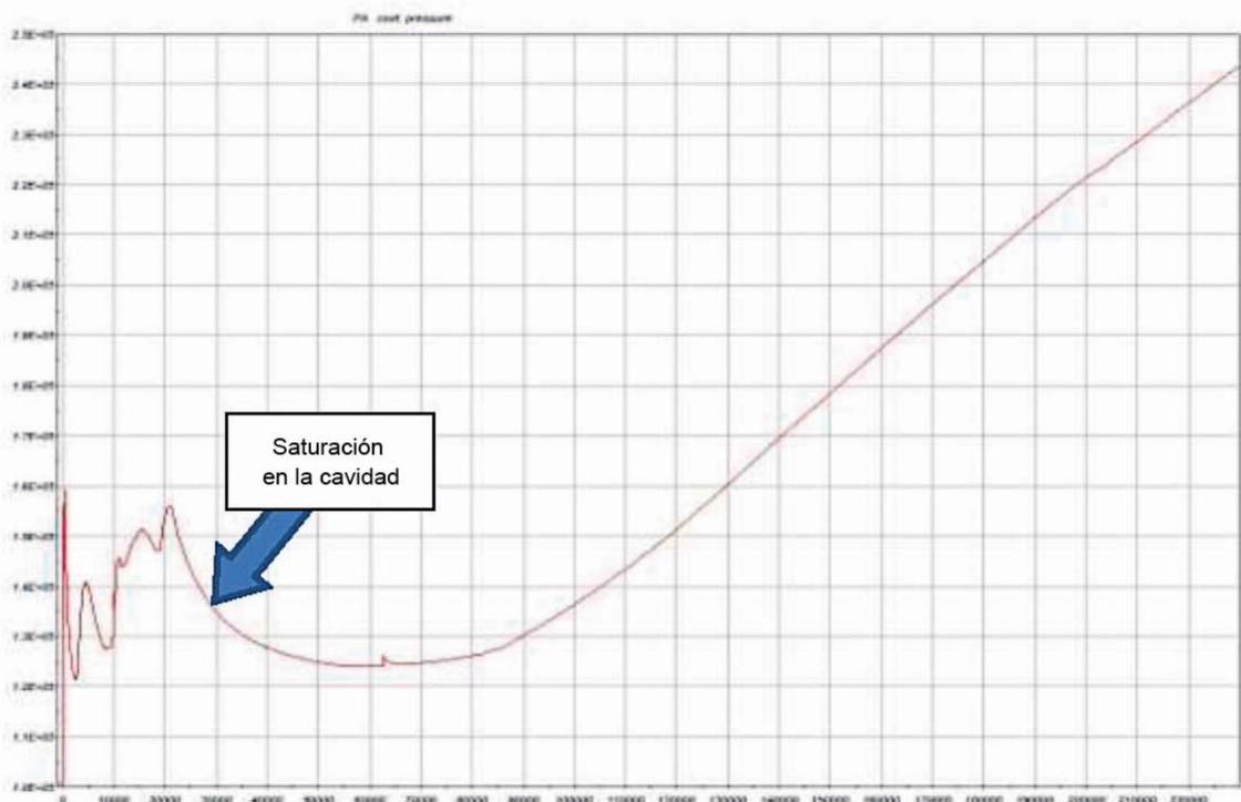
Figura 4-71: Presión de la contención [Pa], tiempo en [s], caso con la conexión de la cavidad abierta y aumento de la cantidad de agua.
