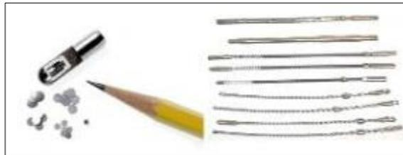
**Figura 2: Fuentes y portafuentes utilizados en gammagrafía industrial**
