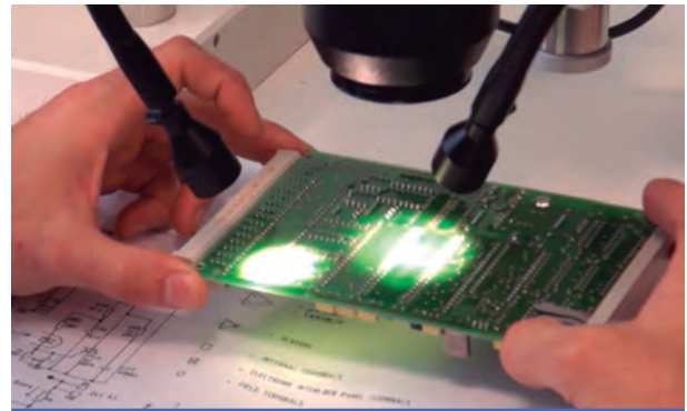
Inspección de módulos electrónicos del panel de instrumentación y control en la Central Nuclear Atucha II
