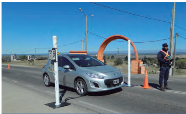
Portal de detección de contaminación para vehículos en el corte de acceso sobre Ruta Provincial N° 5 de Córdoba, altura barrio El Corcovado, durante el simulacro
