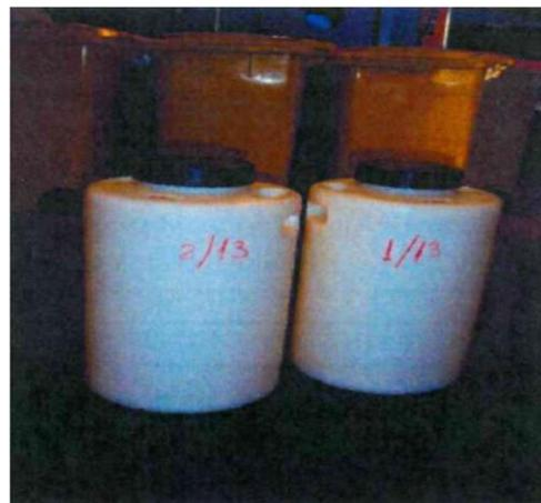
Para ciertos desechos con más actividad (por ej.: fuentes radiactivas decaídas) se utilizan también bultos del Tipo A, con un diseño de embalaje que puede ser algo más complejo y que habitualmente consta de un recipiente externo, otro interno y material de blindaje. En relación con el mantenimiento de estos embalajes, se recomienda ver el punto 7.1.5, por la similitud de su diseño componentes.
