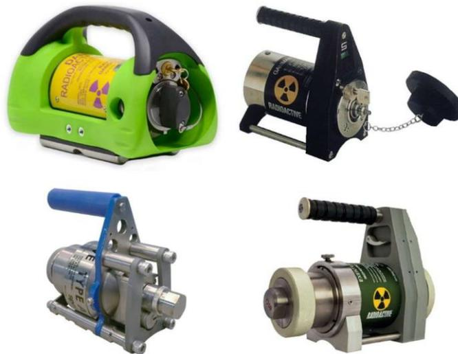
Las estructuras de estos equipos se caracterizan por poseer un blindaje, generalmente de tungsteno o de uranio empobrecido, ubicado en la parte céntrica y montado de forma segura dentro de una carcasa de acero inoxidable. La carcasa está orientada horizontalmente con fines de estabilidad y para facilitar el acceso al mecanismo de bloqueo automático de la fuente y a los accesorios que se usan en los trabajos radiográficos, como el tubo guía y el telemando.
