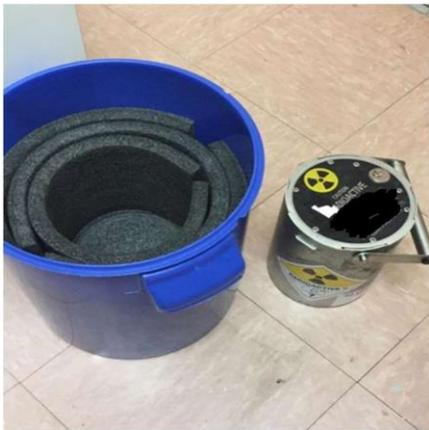
**Contenedor externo, amortiguador de impactos (láminas de polietileno expandido) y contenedor interno blindado**
