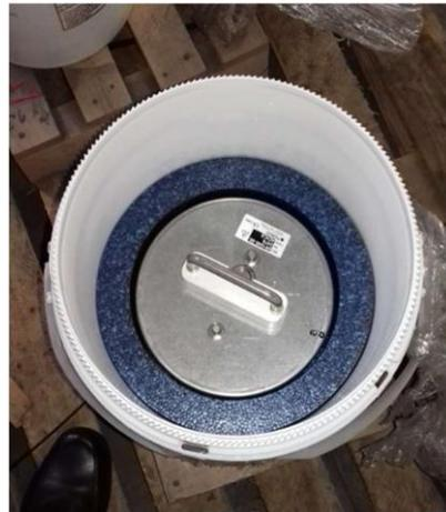
Sistema de inmovilización del contenedor interno en el bulto
