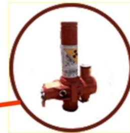
**Medición de densidad del Cemento (Co-60)**
