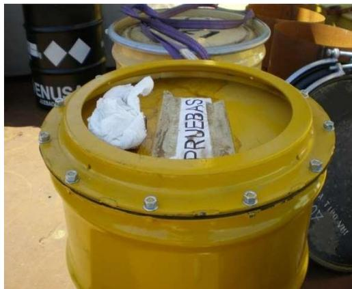
**Sistema de cierre mediante tornillos**
