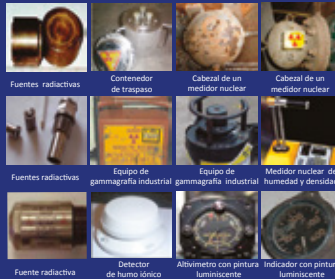
Fuentes radiactivas, Contenedor de trapezoidal, Cabezal de un medidor nuclear, Cabezal de un medidor nuclear, Fuentes radiactivas, Equipo de gammagrafía industrial, Equipo de gammagrafía industrial, Medidor nuclear de humedad y densidad, Fuente radiactiva, Detector de humo iónico, Alímbmetro con pintura luminiscente, Indicador con pintura luminiscente
